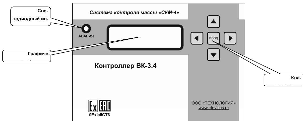
Рисунок Д1. Внешний вид лицевой панели контроллера.
