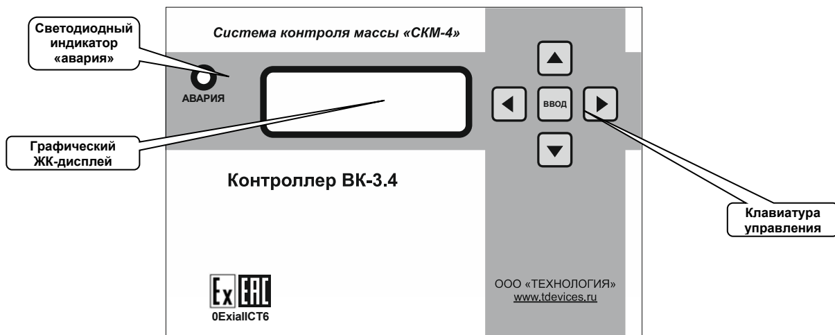
Рисунок Д1. Внешний вид лицевой панели контроллера.
